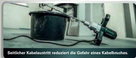
Seitlicher Kabelaustritt reduziert die Gefahr eines Kabelbruches.
