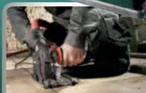
Mit robuster Tischplatte zur winkelgenauen Führung auf dem Material.
