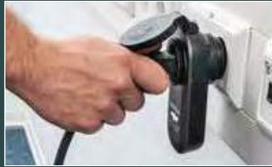
**2.** Sender mit Multiband am Schlauch hinter der Muffe oder direkt an der Maschine befestigen.
