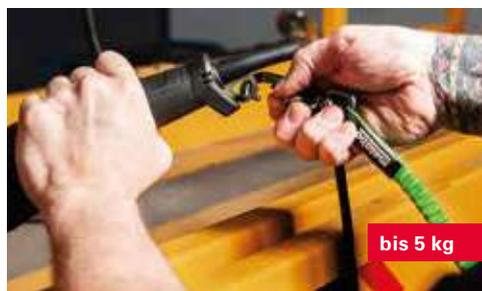
**Werkzeugsicherungsgurt Quick Connect**
