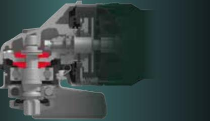
**Metabo S-automatic Sicherheitskupplung:** Direktes mechanisches Entkoppeln des Antriebs bei Blockieren der Scheibe (Anti-Kick-Back) sorgt für reduzierten Rückschlag beim Verklemmen und macht das direkte Weiterarbeiten möglich. Zudem wird das gefährliche Bersten der Trennscheibe verhindert.
